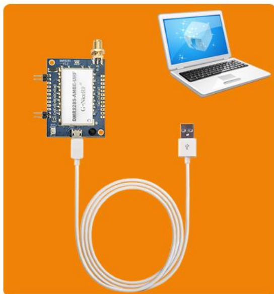
对讲模块USB配置接口连接示意图
